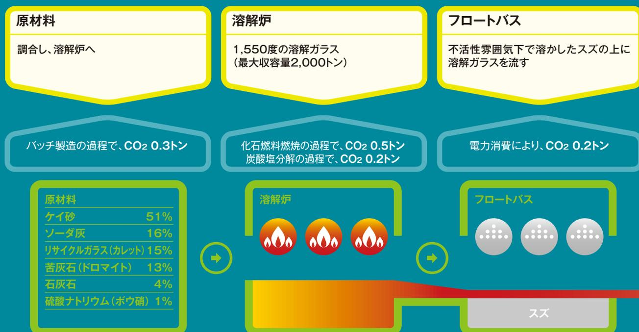
フロート製法にかかるコストで一番大きいものは原材料とエネルギーです。原材料のうち、ガラス素地の重量に占める割合が一番大きいのはケイ砂です。ソーダ灰は最も高価な原材料のひとつで、重量に占める割合は約16%ですが、原材料コストに占める割合は約60%、原材料製造時のCO<sub>2</sub>内包量に占める割合は約75%となります。
